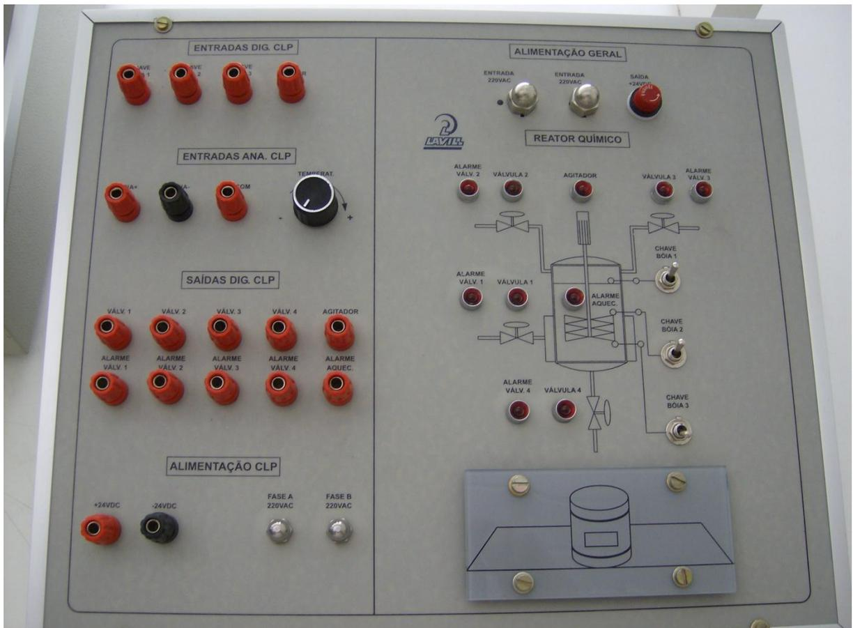
Foto 3.5 - Conjunto kit processo reator para experimentos com CLP.
