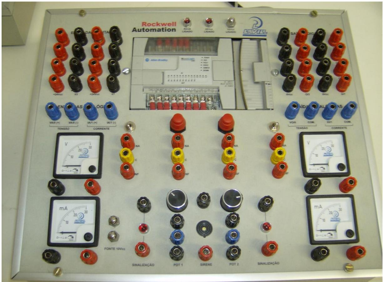
Foto 3.3 - kit de automação para experimentos com controlador lógico programável (CLP).
