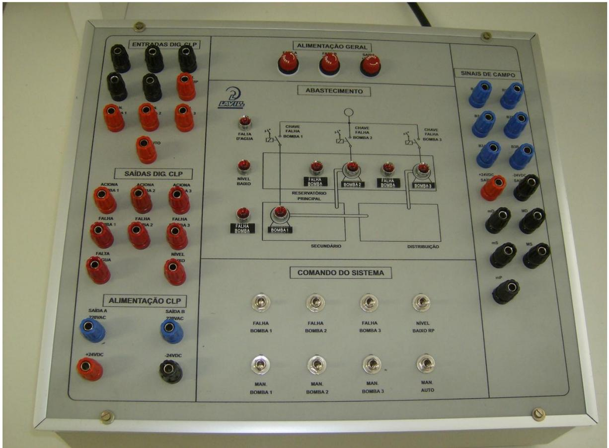
Foto 3.6 - Conjunto kit bombeamento reservatório para experimentos com CLP. (Painel)
