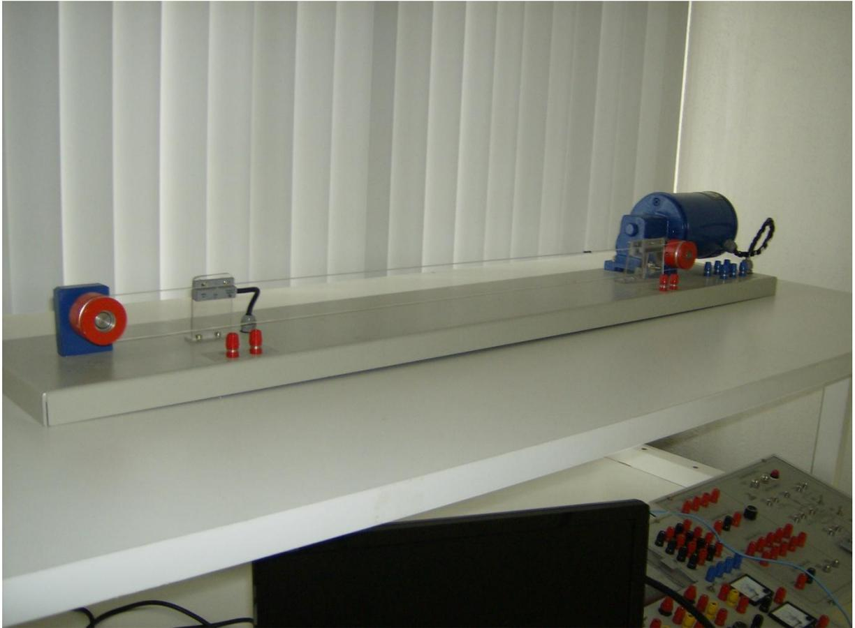
Foto 3.2- Conjunto kit esteira transportadora para experimentos com CLP. (Esteira)
