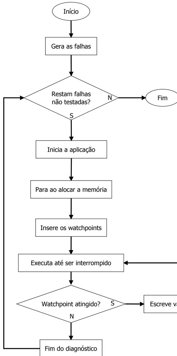
Figura 3.3: Fluxograma do método de inserção de falhas.
