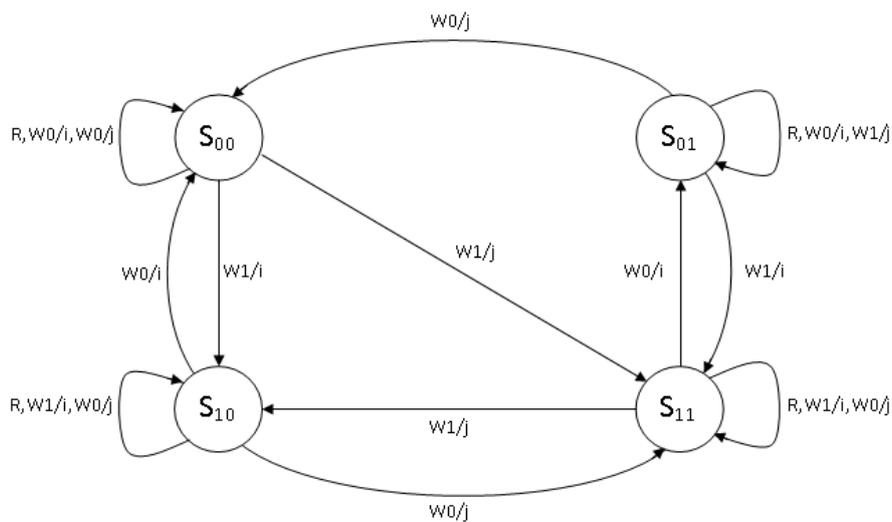
Figura 2.7: Diagrama para duas células com CF. (ADAMS, 2003)
