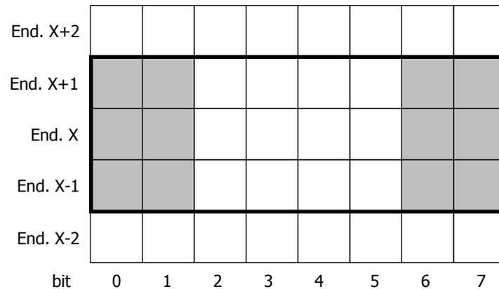
Figura 3.2: Bits atingidos pela inserção de falhas.
