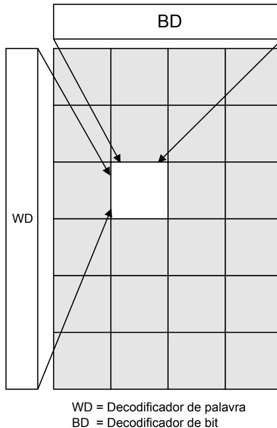
Figura 2.8: Erro não detectável por padrão zero-um.
