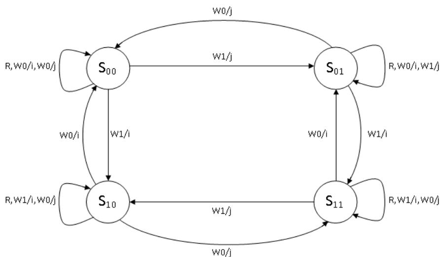
Figura 2.6: Diagrama para duas células sem falhas. (ADAMS, 2003)
