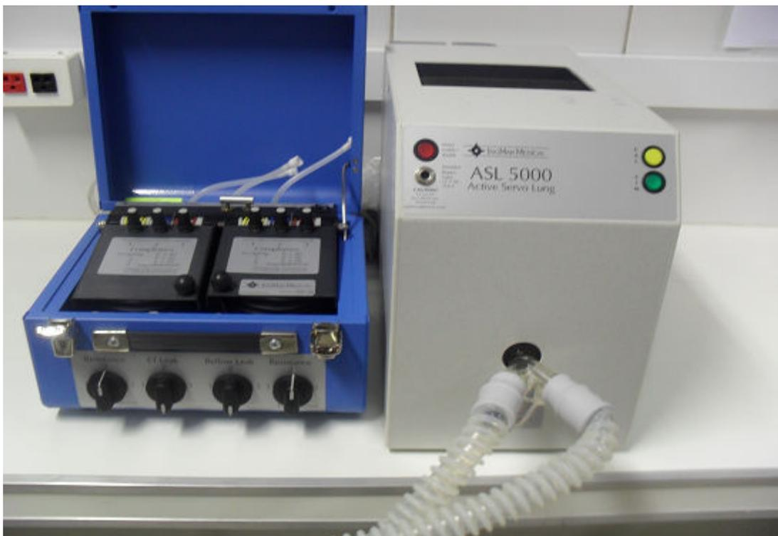
Figura 3.6: simulador Mecânico *ASL 5000*.
